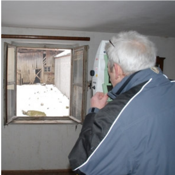
Michael von Sachsenheim aus Unterschleißheim erstellt derzeit das verformungsgerechte Aufmaß für das Wohnhaus und den Stall im denkmalgeschützten Schießl-Anwesen. Foto: Probst
